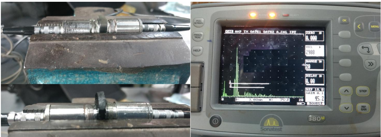
Figura 3. Fotografías de las mediciones de atenuación acústica utilizando la técnica de transmisión, de un bloque de acrílico de 5 mm (superior izquierda) y una muestra de 3 mm (base de acrílico, fotografía inferior izquierda). En la fotografía derecha se puede apreciar la pantalla de una medición realizada sobre la muestra de acrílico
