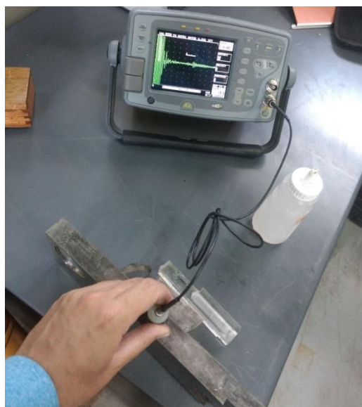
Figura 7. Mediciones preliminares en un bloque V1 del primer sensor.
